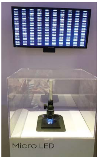
146형 모듈러 TV '더 월'에 사용된 웨이퍼에 LED를 생산해 기판에 붙인 것을 현미경으로 볼 수 있다. /정은미 기자
