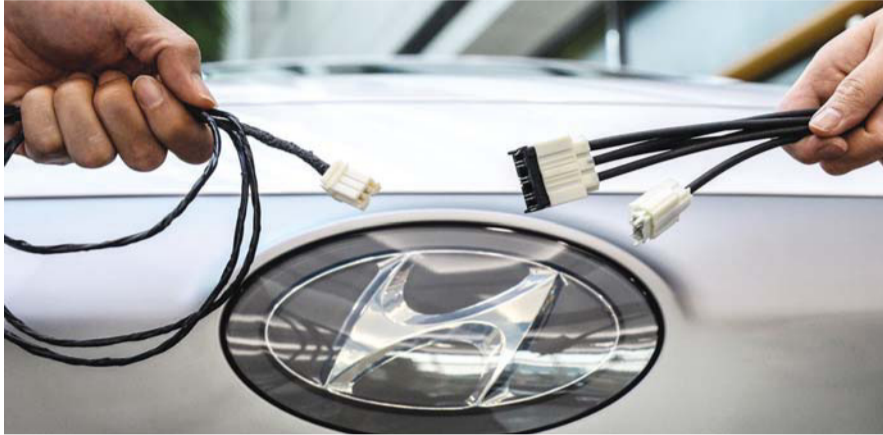
현재 차량 내부에 적용되고 있는 네트워크 케이블(좌)과 현대·기아차가 2019년 이후 커넥티드 카에 적용할 예정인 네트워크 케이블 /현대차그룹 제공
