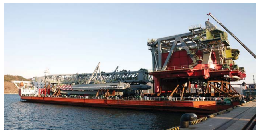
CJ대한통운이 하역에 성공한 해양유전개발용 대형 크레인 'JSD 6000'을 실은 선박이 마산가포신항 항만에 정박해 있는 모습. 전체 무게만 3718톤에 달해 국내에 도입된 해양크레인으로는 최대 규모다. /CJ대한통운
