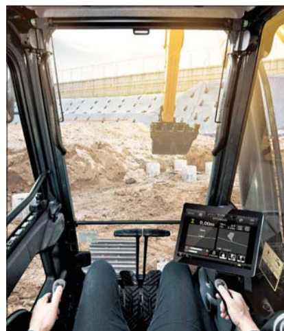
머신가이던스 탑재된 현대건설기계 굴삭기 내부.
