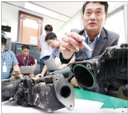
6일 정부세종청사 국토교통부에서 김경욱 교통물류실장이 BMW측에 차량화재관련 조치를 요구한 뒤 목포 주행 중에 화재가 발생한 BMW 디젤차량의 배기가스 재순환 장치(EGR, 왼쪽)를 공개하고 있다. / 연합뉴스
