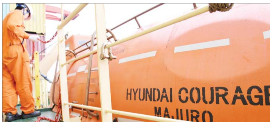
퇴선 등 비상용으로 쓰이는 구명정. 구명정은 탑재돼 있는 엔진을 이용해 최대 40km를 이동할 수 있다. 구명정엔 비상식량·식수·소화기 등도 있다.
