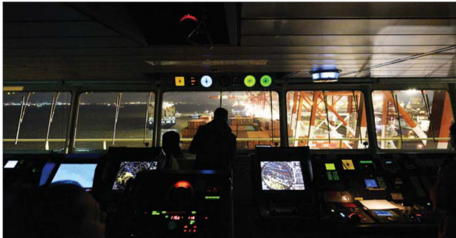
현대캐리지호가 중국 상하이항을 출발하기 위해 준비중이다. 배가 밤에 출항할 때는 가시거리 확보를 위해 조종실인 브리지의 불을 끈다.
