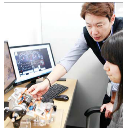
현대위아 연구원들이 12일 경기도 의왕시 현대위아 의왕연구소에서 4륜 구동 통합 제어 부품인 '전자식 커플링'을 테스트하고 있다. /현대위아
