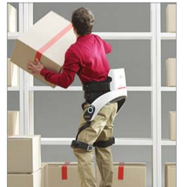
지난해 열린 CES 2018 삼성전자 부스 체험모습과 산업현장이나 상업, 물류공간에서 사용자의 허리근력을 보조하는 'LG 클로이 슈트봇'. /각사
