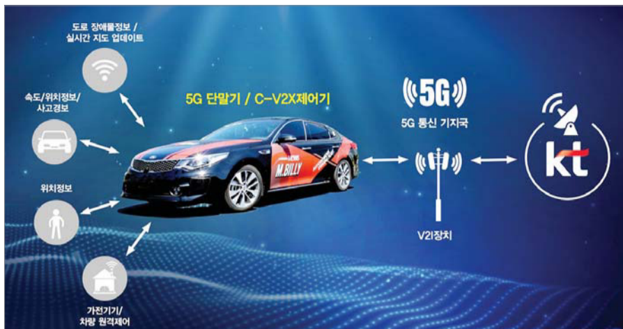
5G 기반 커넥티드카 기술 구현 개념도(왼쪽)와 5G 인프라를 활용한 엠빌리 자율주행차가 교차로를 지나고 있다.
