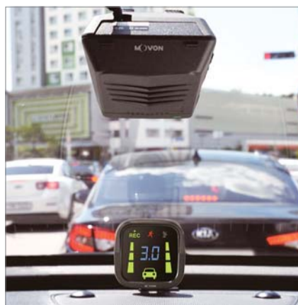
차량에 설치된 파워 ADAS 솔루션이 운전자에게 전방 충돌, 차선 이탈, 안전 거리 및 속도 등 위험 요소를 미리 알려주고 있다. /KT파워텔
