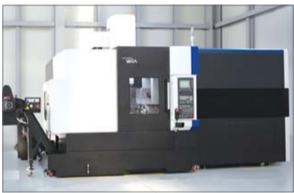
현대위아와 인스텍이 함께 개발한 '3D프린팅 하이브리드 가공기'의 모습 /현대위아
