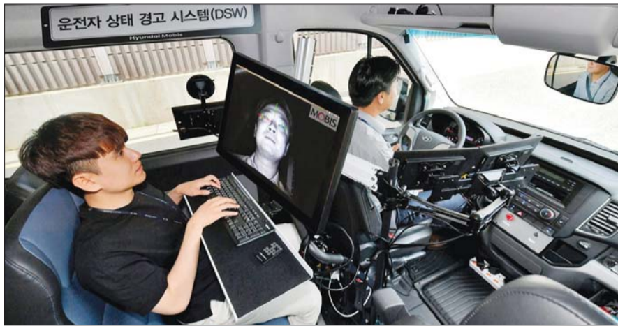
현대모비스 연구원이 운전자 동공추적과 안면인식이 가능한 ‘운전자 부주의 경보시스템’을 상용차에 적용해 시험하고 있다.
