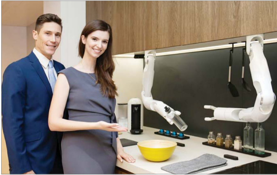
삼성전자 모델들이 삼성봇 세프를 선보이고 있다. '삼성봇 세프'는 로봇 팔에 다양한 도구를 바꿔 장착함으로써 식재료를 자르고 섞거나 양념을 넣는 등의 요리 보조 기능을 지원하며, 레시피를 다운로드 받아 필요한 작업을 수행할 수 있다. /삼성전자
