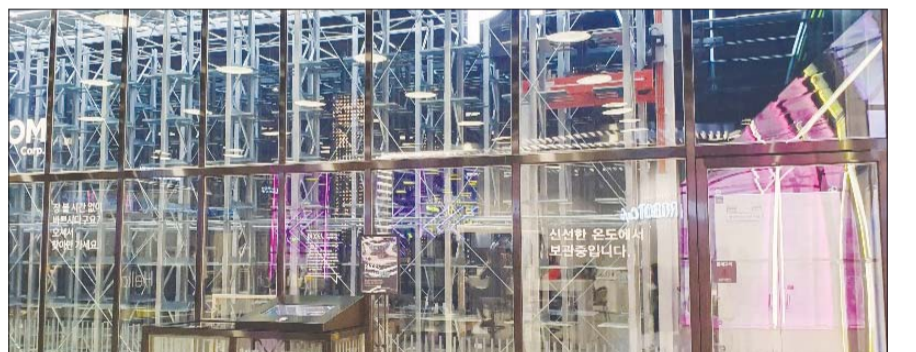
10일 이마트 최초로 청계천점에 오픈한 SSG닷컴이 운영하는 '픽셀(PIXEL)' 온·오프라인 통합 픽업 시스템. SSG닷컴에서 주문한 상품을 키오스크에 바코드를 입력하면 크레인 로봇이 배송해준다. /채윤정 기자
