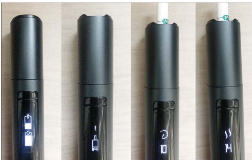
(왼쪽부터) 배터리·카트리지가 잔량 표시가 되고, 스틱을 꽂았다가 바로 빼면 예열 표시가 뜬다. 또 가열 완료 10초 전에는 디스플레이에 남은 시간을 알려준다. 가열이 완료되면 흡입 가능 횟수를 표시해 준다.
