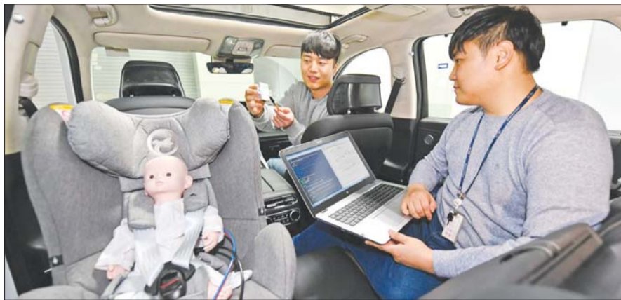
현대모비스가 레이더 기반 탑승객 감지시스템 개발에 성공했다. 현대모비스 용인 기술연구소에서 연구원들이 탑승객 감지시스템을 시험하고 있다.
