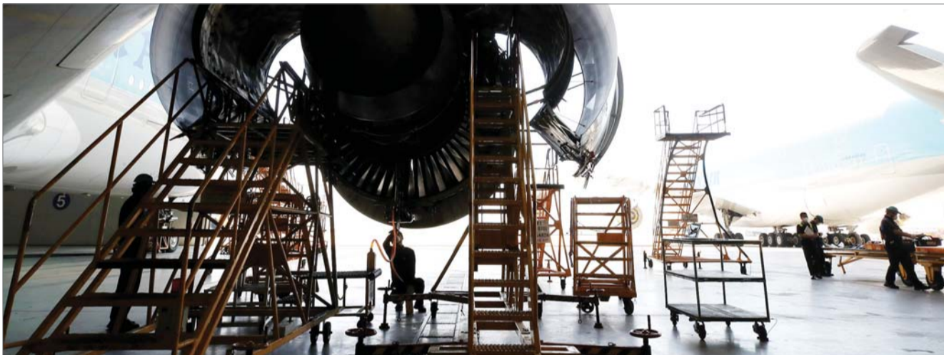
다시 날아오를 그 날을 위해 11일 오전 인천 중구 운서동 대한항공 정비 격납고에서 정비사들이 A-380 항공기 정비 작업을 하고 있다. 이번 정비 작업은 항공기 ‘단기 보관(장기 주기)’에 대비한 정비 작업의 일환으로 단기 보관 중인 항공기의 경우라도 언제든지 운항에 투입할 수 있도록 항공기 외부, 타이어, 랜딩기어, 전자장비 등 다양한 부문에 대한 체크가 실시됐다. /연합뉴스
