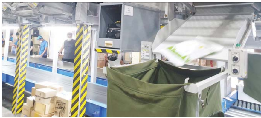
2층에 설치된 MP소터로 자동 분류된 소형 택배 상품이 택배기사가 있는 1층으로 전달되고 있다. /CJ대한통운
