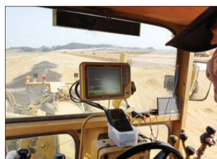
건설현장에서 한 운전자가 MC(Machine Control) 시스템을 이용해 작업 중이다. /현대건설
