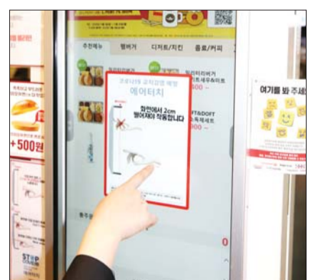
롯데리아 매장에 설치된 비접촉식 ‘에어택트 스크린’
