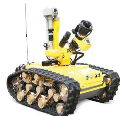
현재 양산 중인 중신중공업카이칭인텔리전스의 배터리형 소방로봇
