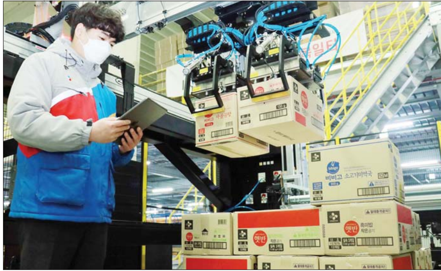
CJ대한통운 e-풀필먼트센터에 적용된 인공지능 기반 AI 로봇 디팔레타이저.
