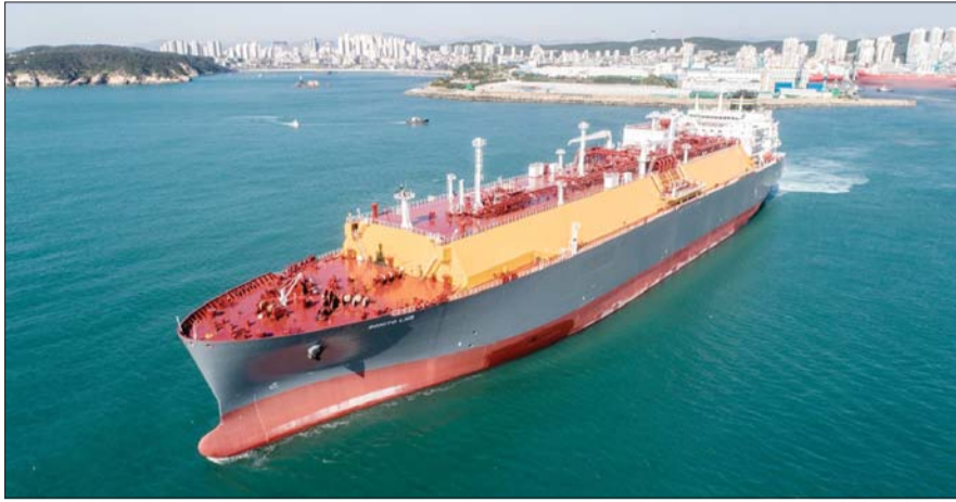
현대중공업이 건조한 17만 4천 입방미터급 LNG운반선의 시운전 모습
