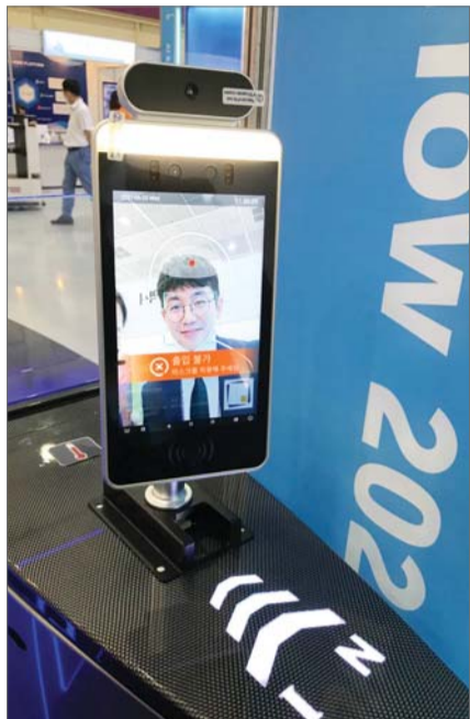
와이즈넷 직원이 지난달 말 코엑스에서 개최된 '스마트테크코리아' 전시회에서 발열감지 기능을 갖춘 AI 얼굴인식 출입통제 시스템을 시연하고 있다. 이 시스템을 적용하면 마스크를 착용하지 않으면 출입이 불가하며 마스크를 착용하라는 안내를 해준다. /채윤정 기자
