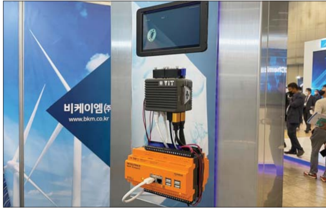
비케이엠이 선보인 Edge AI기반의 연료전지 실시간 진단·제어 통합솔루션 VIT E(위쪽부터)와 VIT C.
