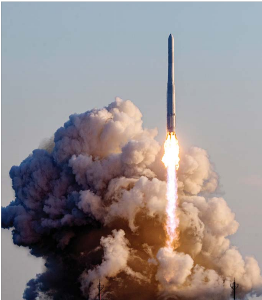
한국형 발사체 누리호(KSLV-II)가 21일 고흥군 나로우주센터 제2발사대에서 화염을 내뿜으며 힘차게 날아오르고 있다. 누리호는 1.5t급 실용위성을 지구저궤도(600~800km)에 투입하기 위해 만들어진 3단 발사체이며 엔진 설계에서부터 제작, 시험, 발사 운용까지 모두 국내 기술로 완성한 최초의 국산 발사체이다. /뉴스시스
