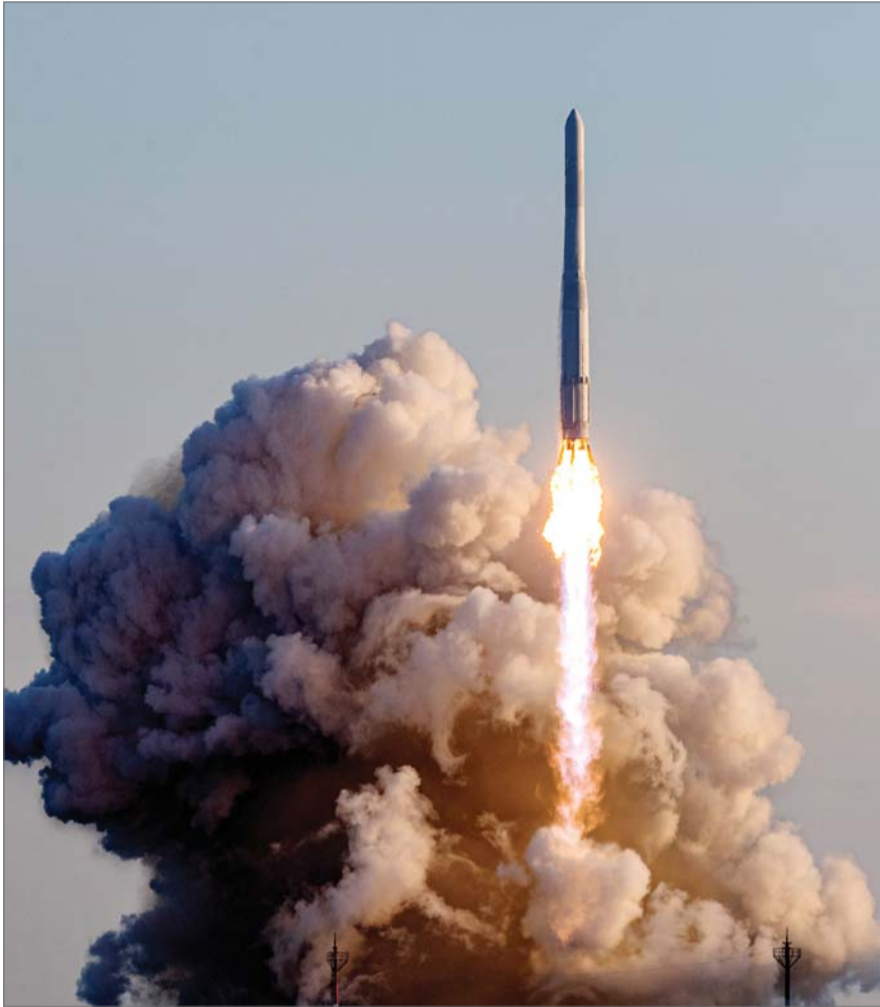
한국형 발사체 누리호(KSLV-II)가 21일 고흥군 나로우주센터 제2발사대에서 화염을 내뿜으며 힘차게 날아오르고 있다. 누리호는 1.5t급 실용위성을 지구저궤도(600~800km)에 투입하기 위해 만들어진 3단 발사체이며 엔진 설계에서부터 제작, 시험, 발사 운용까지 모두 국내 기술로 완성한 최초의 국산 발사체이다. /뉴스1
