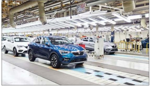
부산 공장은 높은 자동화율과 철저한 검사 시스템으로 불량률을 최소화했다. (왼쪽부터) 품질을 확인하는 비전 장비가 차량 곳곳을 찍는 모습. 조립이 마무리된 차량이 검사를 받는 모습.
