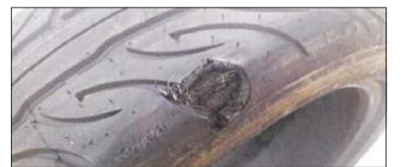
제크노바 타이어 주행시험 이후 파손이 확인된 모습 /국표원
