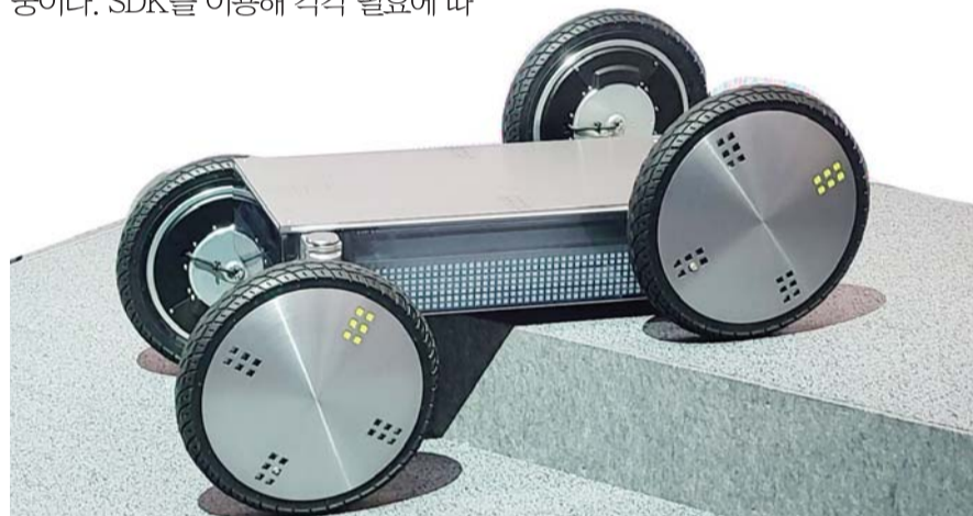
모베드는 4면에 바퀴를 자유자재로 조절하면서 다양한 형태로 작동하며 경사나 계단 같은 지형 변화에도 원활한 이동이 가능했다. /김재용 기자
