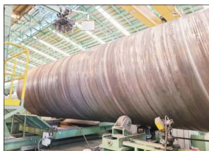
세아제강이 포스루프355를 이용해 제작하고 있는 직경 2.5m의 하이퍼루프 튜브.
