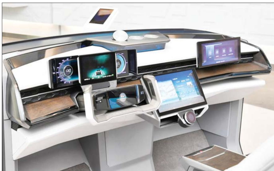
현대모비스가 지난해 공개한 콕핏시스템 엠빅스는 심전도 센서, 운전자 모니터링 카메라, 멀미 저감 신기술 등을 탑재해 자율주행을 돕는다.
