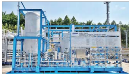
대우조선해양의 암모니아 연료공급시스템 실증 설비
