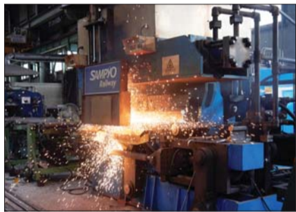
삼표레일웨이가 인도가 수출한 FBW(Flash Butt Welding) 머신.
