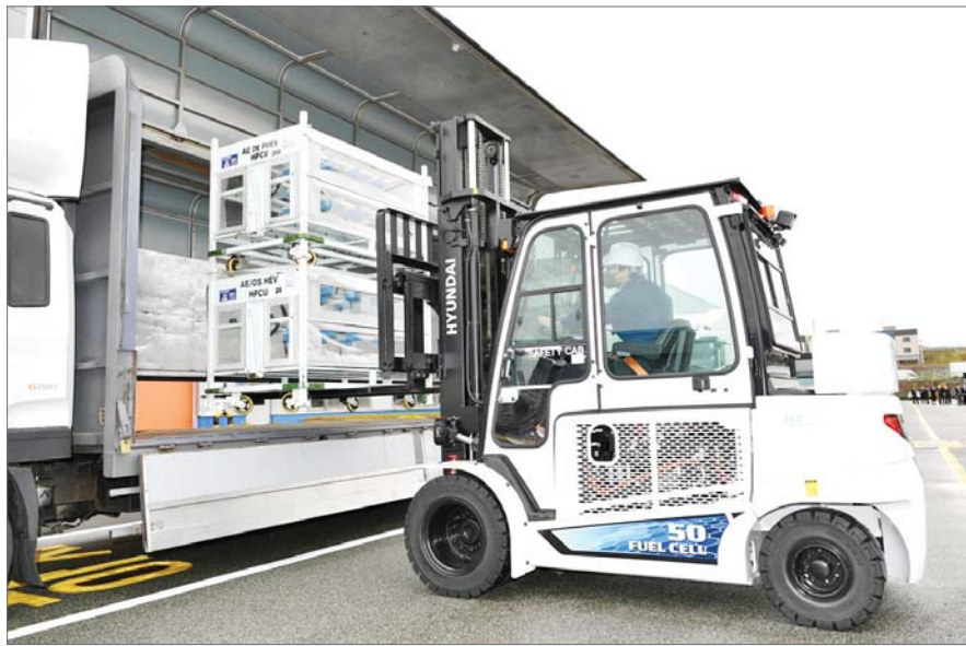
수소모빌리티 실증사업이 진행되는 현대글로벌 울산 KD 센터에서 작업자가 수소지게차를 이용해 작업을 하고 있다.
