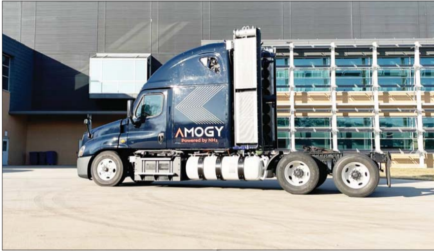
SK이노베이션이 투자한 암모니아 기반 수소 연료전지 시스템 Amogy가 이달 초 미국 뉴욕주 스톤브룩에서 세계 최초로 암모니아를 동력원으로 주행시험하는데 성공한 트럭. /SK이노베이션
