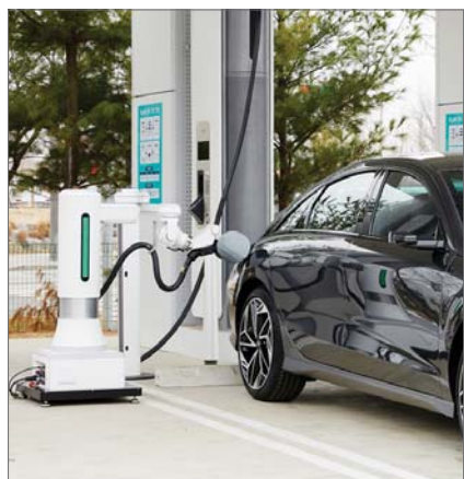
현대차그룹이 전기차 충전기의 케이블을 대신 들어 차량 충전구에 체결해주고 충전이 완료되면 충전기를 제자리에 돌려놓는 외팔형 전기차 충전 로봇을 공개했다. /현대차그룹
