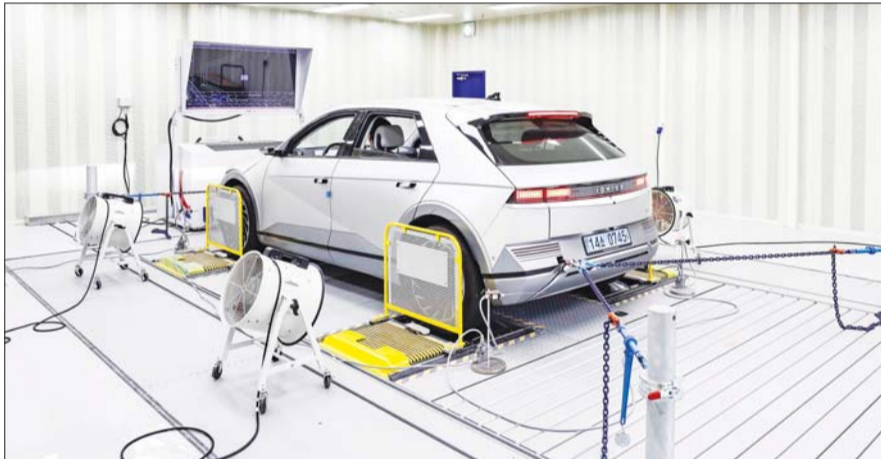
전기차의 전비 측정 및 분석, 주행 재현을 통한 전기차의 성능을 평가하고 있다
