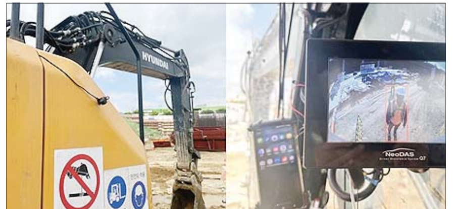
현장 굴착기에 부착된 추후방 카메라(왼쪽) 및 디스플레이 내 인체 인식 장면. /DL건설
