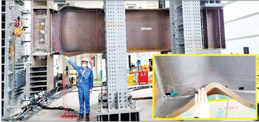
지난해 12월 송도 포스코 철강솔루션연구소 강구조 실험실에서 실시된 세계 최고 보 높이 1500mm Pos-H보·기둥 접합부 내진 실험 장면(대규모의 지진력이 작용하더라도 보와 기둥의 파단 없이 보가 끝까지 지진에 견디는 것을 볼 수 있다).
