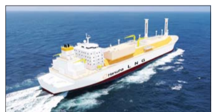
로터세일, 탄소포집장 등 차세대 친환경 기술이 대거 적용된 한화오션의 그린십 사양 LNG 운반선 조감도
