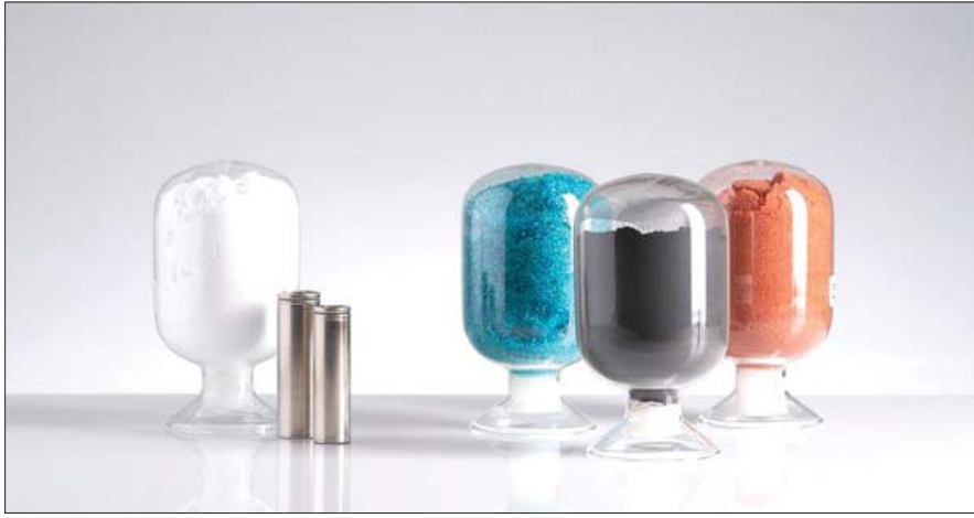
전기차 배터리 원료 및 소재 샘플과 원통형 배터리 사진. (왼쪽부터)리튬, 원통형 배터리, 니켈, 양극재, 코발트. 리튬은 가장 가볍고 반응성이 강한 금속이다. /포스코케미칼
