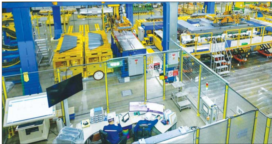
지난 7일 HD현대일렉트릭이 ‘HD현대일렉트릭 울산 변압기 스마트 공장 투어’에서 철심자동적층설비를 소개했다. /HD현대일렉트릭
