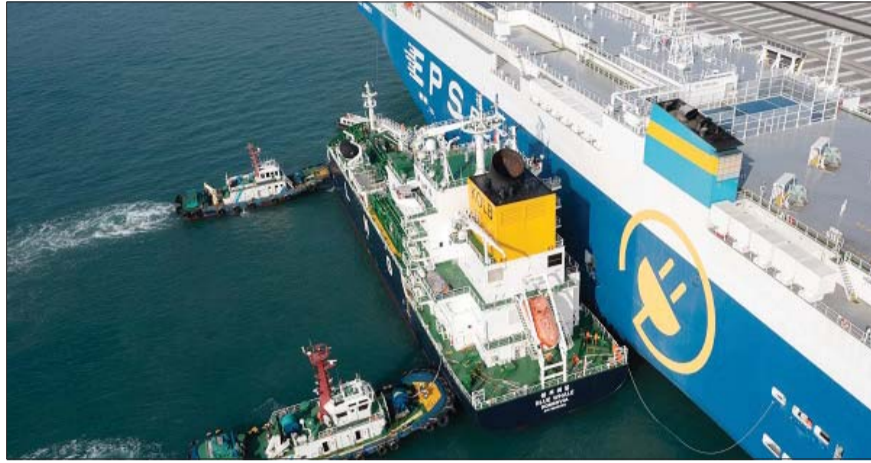
LNG 빙커링선 블루웨일호가 자동차운반선에 LNG연료를 빙커링하고 있다.
