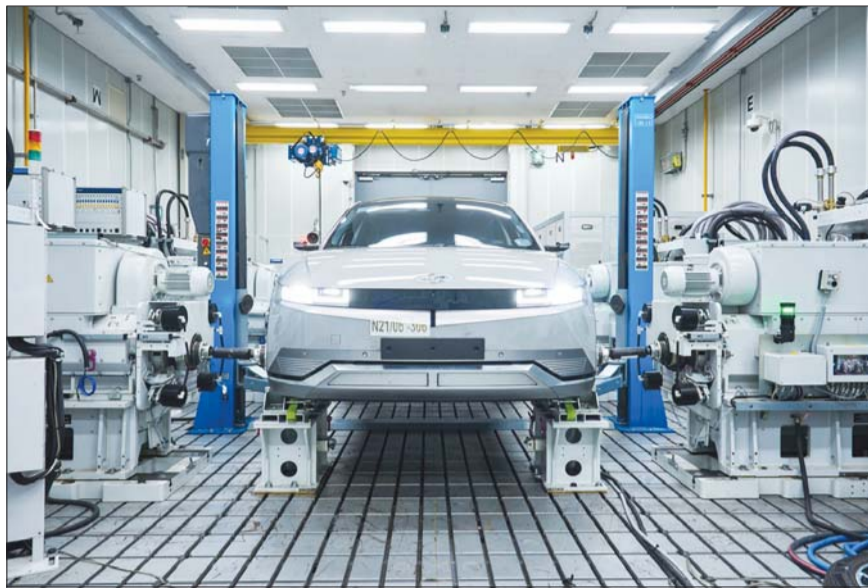
현대차 남양연구소 전기자동차 동력계 시험실에 위치한 4축 동력계 시험실.
