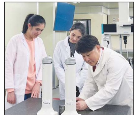
한국폴리텍대학 반도체융합캠퍼스 나노측정과 정현석 학과장이 파르비나(첫 번째), 샤희조다 자매에게 하이트 마이크로미터 장비를 이용한 높이 측정 실습을 지도하고 있다. /한국폴리텍대학
