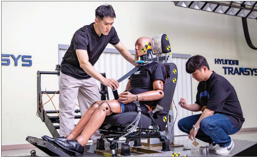
연구원들이 충돌 상황을 가정해 대차(슬레드) 위에 더미가 탄 시트를 올린 시험을 진행하고 있다.
