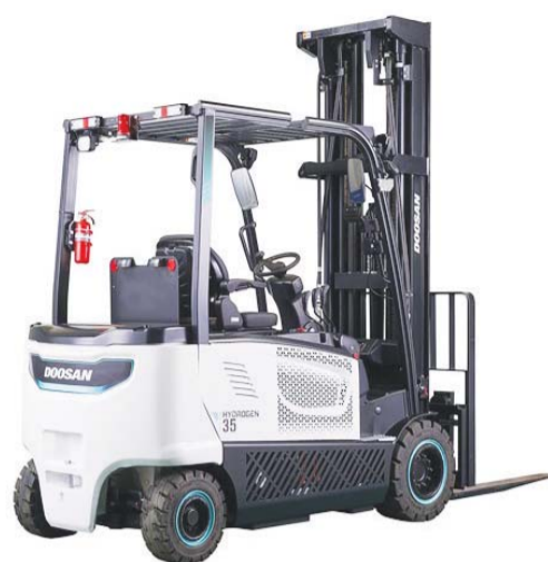
두산밥캣의 3톤급 20kW 수소 연료전지 지게차. /두산밥캣
