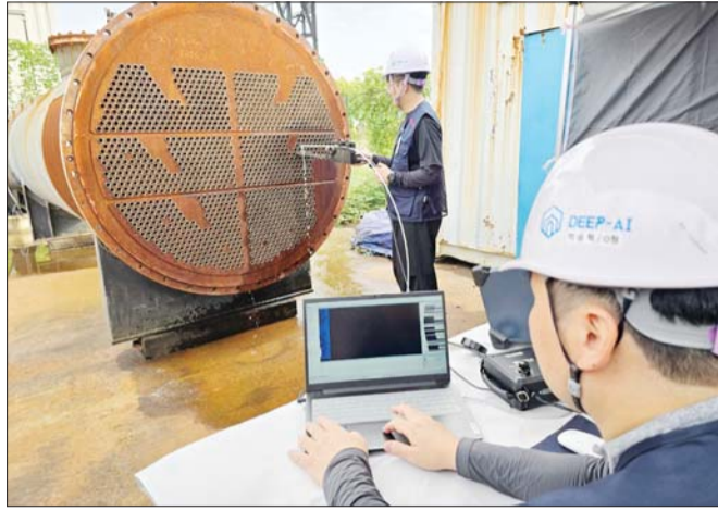
SK이노베이션이 'AI 비파괴검사(IRIS) 자동 평가 솔루션'으로 열교환기 결함 검사를 하고 있다. /SK이노베이션
